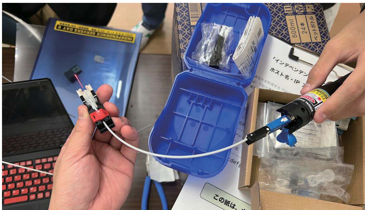
図 7：光ケーブル自作（成端）体験コーナーにおける、 可視光を用いた光ファイバケーブルの構造の提示・光信号の伝送の実演
