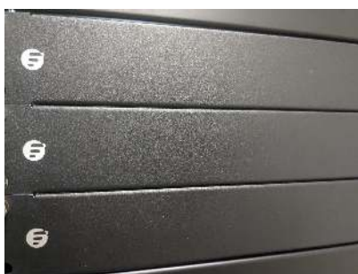
図 18: FS の物同士であれば隙間はほぼ空いていない。
