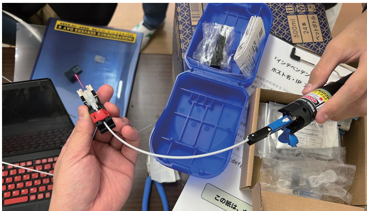
図 7：光ケーブル自作（成端）体験コーナーにおける、 可視光を用いた光ファイバケーブルの構造の提示・光信号の伝送の実演（'24 撮影）
